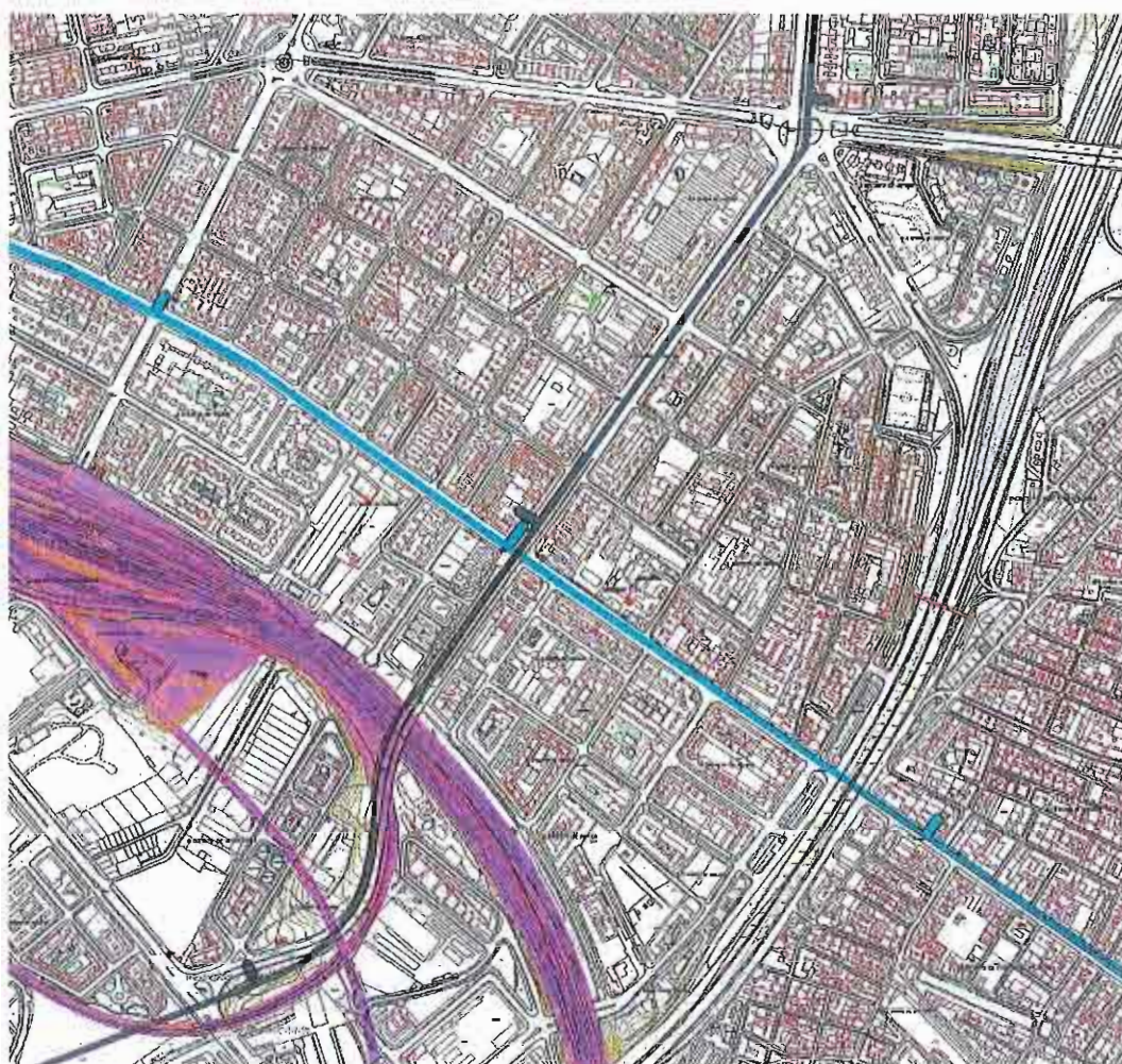
Esquema de infraestructuras ferroviarias y de metro existentes en el ámbito de la alternativa 1 que podrían verse afectadas o afectaría a su funcionamiento.
